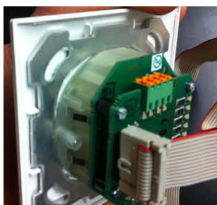
Bild oben Rückansicht: Alle IO Linien und Speisung sind auf ein Flachbankdkabel herausgeführt.
