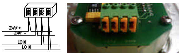
Anschlüsse: 24VDC (+)(-) und 2Draht LON FT10. Speisung - und Busdrähte sind verpolungssicher.
